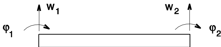
Bild 2-14: Alternative Darstellung der Stabkräfte
