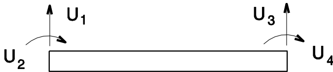
Bild 2-13: Die Kräfte am Balken
